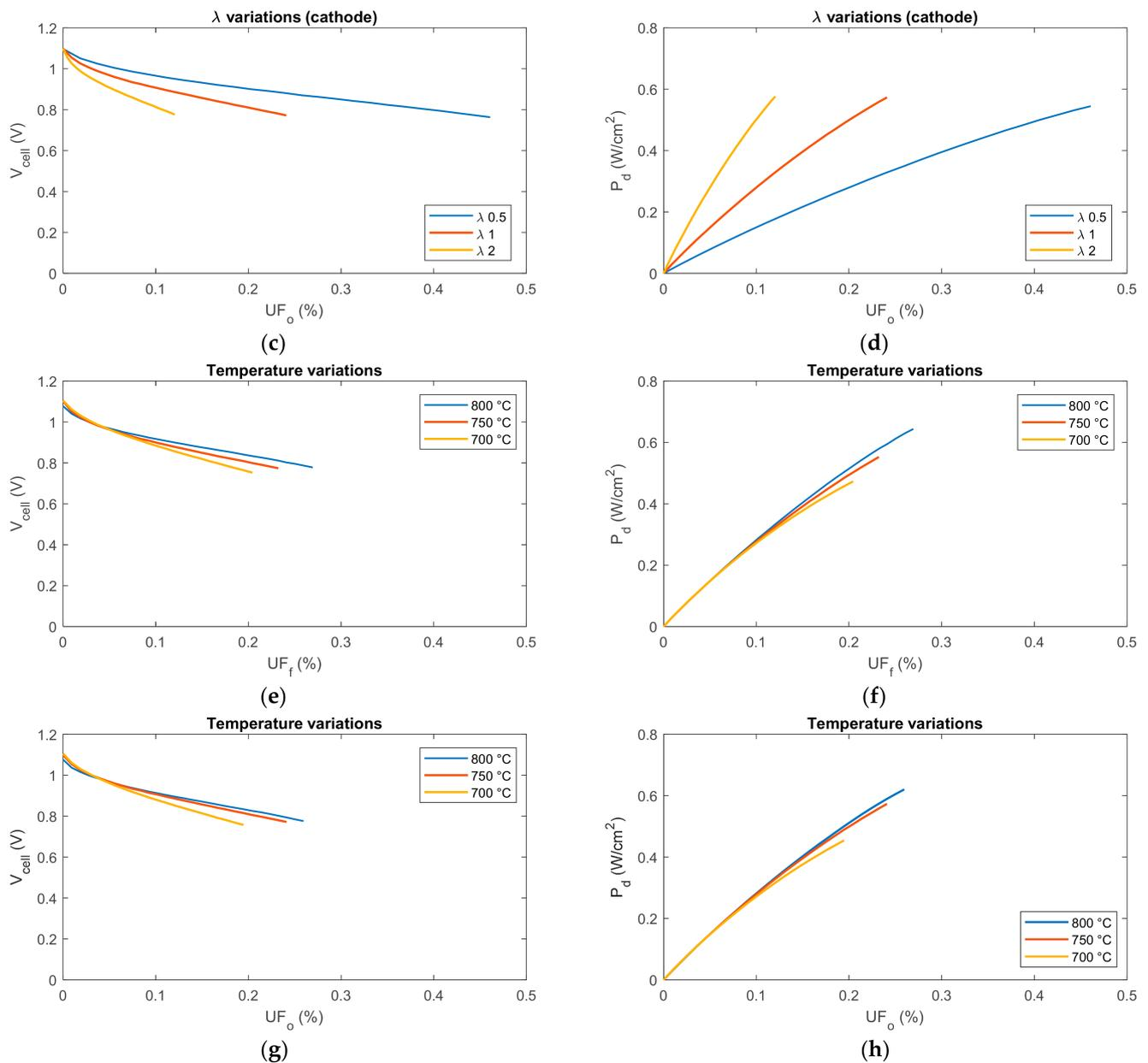
**Figure 7.** Experimental performance curves vs.  $UF_f$  &  $UF_o$ : (a,b)  $UF_f$ - $H_2\%_{vol}$  variations ( $T = 750\text{ °C}$ ;  $\lambda = 1.4$ ); (c,d)  $UF_o$ - $\lambda$  variations ( $T = 750\text{ °C}$ ;  $H_2\ 50\%_{vol}$ ); (e,f)  $UF_f$ - $T$  variations ( $H_2\ 50\%_{vol}$ ;  $\lambda = 1$ ); (g,h)  $UF_o$ - $T$  variations ( $H_2\ 50\%_{vol}$ ;  $\lambda = 1$ ).
